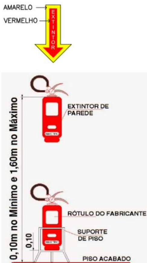
Fig. 02 – Detalhe fixação extintores
